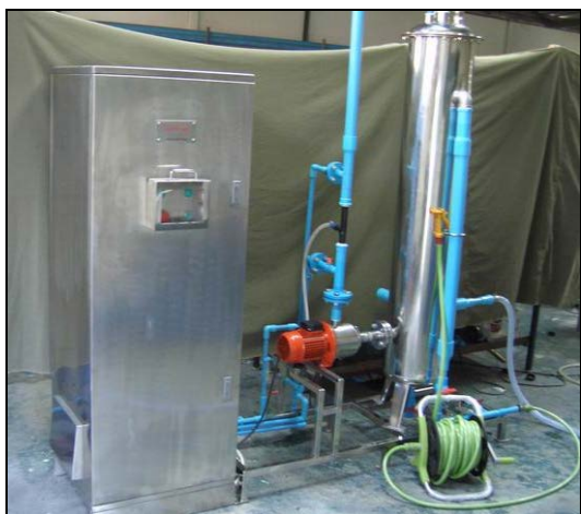
ชุดผลิตน้ำโอโซนล้างฆ่าเชื้อโรค โรงงานบริษัท บี. ฟู้ดส์ โปรดักส์ อินเตอร์เนชั่นแนล จำกัด
